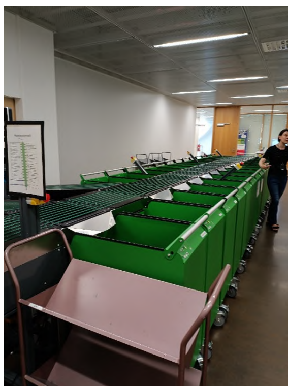
Urządzenie przyjmujące i rozdzielające zwroty. Fot MG
